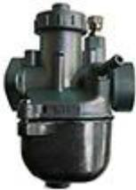
Der Benzinschlauchanschluß zeigt flach nach hinten. Luftkanäle, Düsen und Teillastnadel sind optimiert für Bohrungsdurchmesser und Steuerzeiten.
