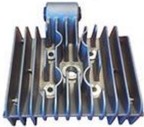
Diese Variante der S51 Motorbefestigung im KR51/1 ist hinsichtlich Stabilität und Komfort der KR51/2 Variante überlegen. Das Anbringen einer neuen Bohrung in den Rahmenblechen für eine zweite Schraube zur Aufhängung des S51 Motors hinten unten entfällt.
