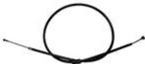
Der Kupplungsbowdenzug ist wegen der Platzierung des Kupplungshebels am Motor und der Aufnahme am Lichtmaschinenendeckel insgesamt etwas länger und sein Funktionsweg größer als beim KR51/1.
