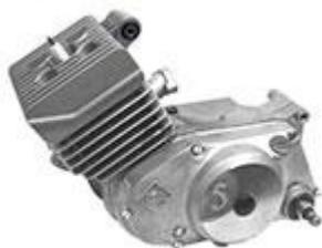
Zudem ist es ratsam, die Funktion der einzelnen Baugruppen zu überprüfen (z.B. Kickstartmechanismus, Schaltung, Kupplung, Abdichtungen, Kugellager). Mögliche Defekte lassen sich am noch ausgebauten Motor besser abstellen und ersparen Mehrarbeit im Nachgang.
