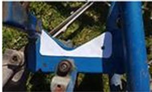
Nun wird im unteren Bereich der vom Rahmenblech überstehende und zu entfernende Teil z.B. mittels Edding-Stift markiert. Zur Entfernung eignet sich z.B. ein Winkelschleifer mit Fächerscheibe.
